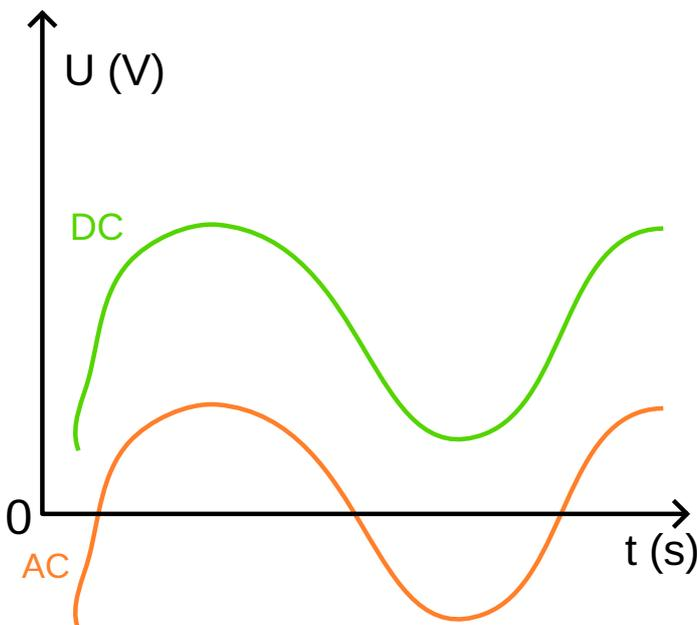
Ainsi, lorsque l'on sélectionne AC, on applique un filtrage au signal pour ne garder que la partie alternative et enlever la partie continue. La partie continue a une période qui tend vers l'infini, donc une fréquence qui tend vers 0. On applique donc un filtre passe-haut avec une fréquence de coupure de l'ordre du Hz.
